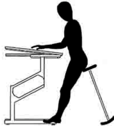
Sitzhöhe maximal 830 mm. Hublänge der Gasfeder 260 mm.
