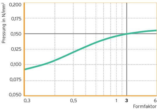
Abb. 5: Statischer Einsatzbereich in Abhängigkeit des Formfaktors
