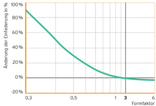
Abb. 6: Einfederung<sup>5</sup> in Abhängigkeit des Formfaktors
