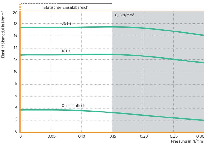
Abb. 2: Belastungsabhängigkeit des statischen und dynamischen Elastizitätsmoduls
