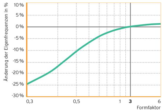
Abb. 8: Eigenfrequenz<sup>5</sup> in Abhängigkeit des Formfaktors
