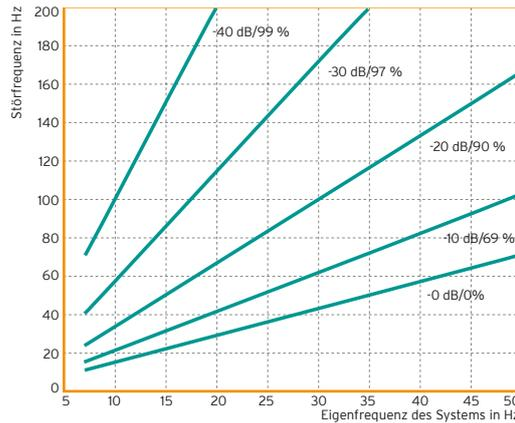
Verminderung der Übertragung mechanischer Schwingungen durch den Einbau einer elastischen Lagerung aus Sylodyn® ND
