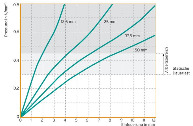
Quasistatische Federkennlinie mit einer Verformungsgeschwindigkeit von 1 % der Dicke pro s; Prüfung zwischen ebenen Stahlplatten; Aufzeichnung der 3. Belastung; Prüfung bei Raumtemperatur
