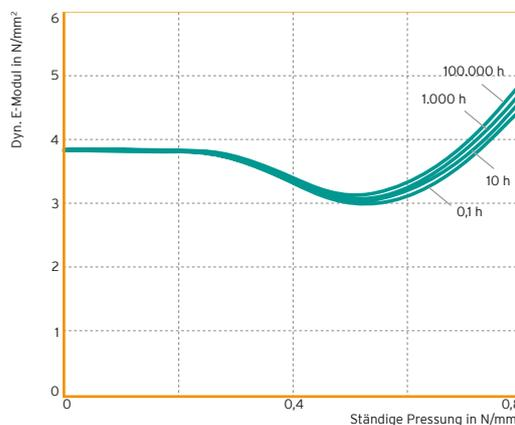
Veränderung des dynamischen Elastizitätsmoduls unter gleich bleibender Druckbelastung (bei 10 Hz)
