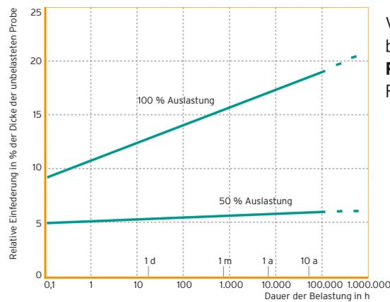
Verformungszunahme unter gleich bleibender Druckbelastung
