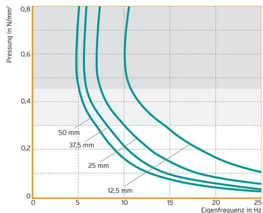
Statischer E-Modul als Tangentenmodul aus der Federkennlinie; Dynamischer E-Modul aus sinusförmiger Anregung mit einer Schwinggeschwindigkeit von  $100 \text{ dBv re. } 5 \cdot 10^{-8} \text{ m/s}$ ; Messung in Anlehnung an DIN 53513
